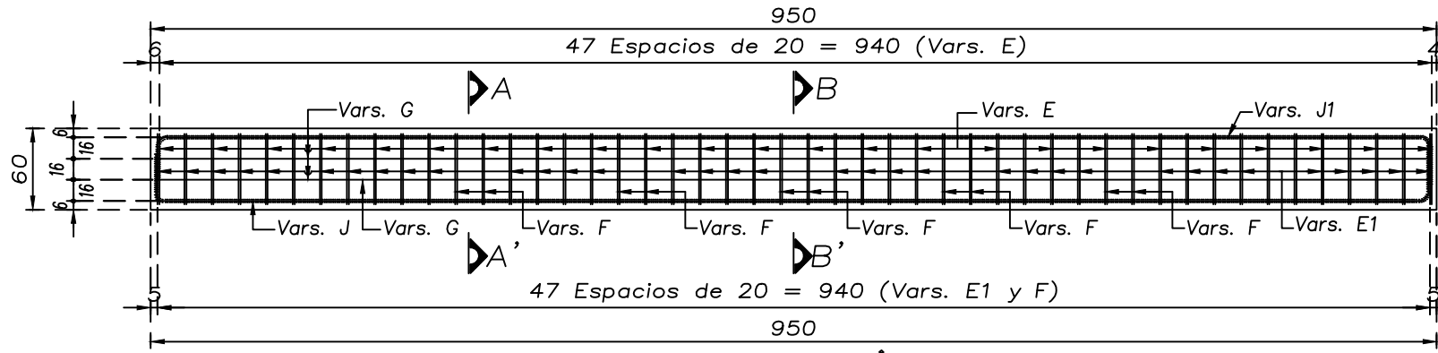
CORTE C-C' ELEVACION DE CORONA ESC. 1:50
